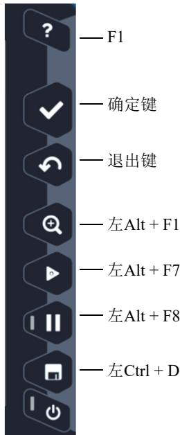
图 10-4 OmniScan X3 仪器的快捷方式
