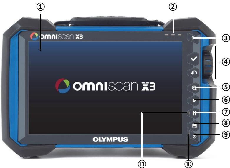
图 1-1 OmniScan X3 探伤仪前面板上的控制装置
