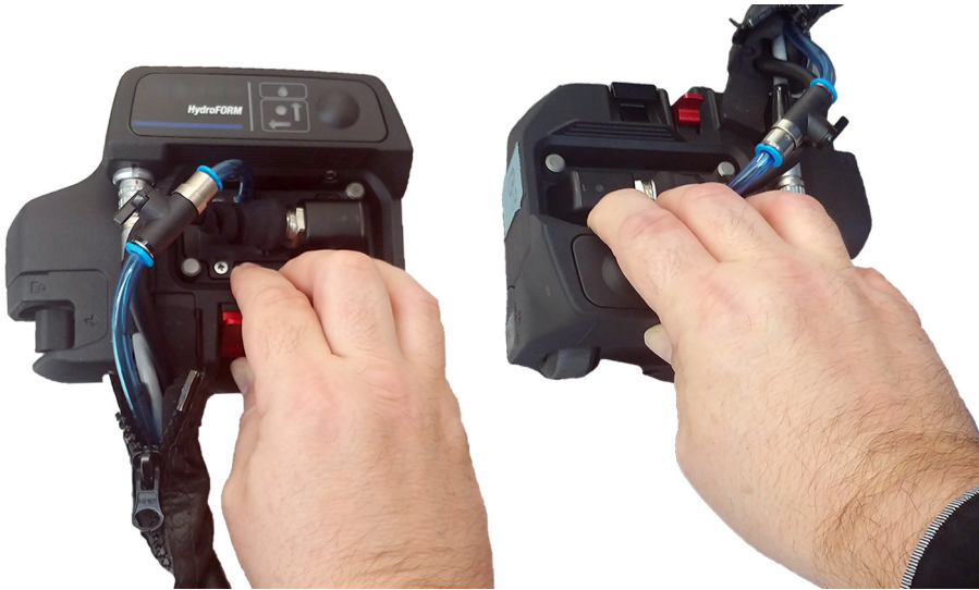
Figura 4-1 Posições das mãos durante o escaneamento
