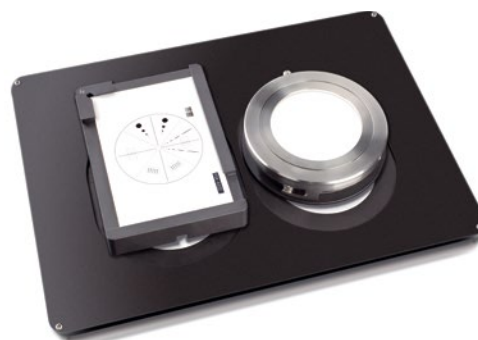
Integrovaný kalibrační etalon pomáhá dodržovat pravidelné ověřování systému.
