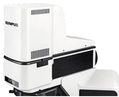
Osvětlovací systém a kamera chráněné krytem zabraňujícím náhodnému vychýlení.
