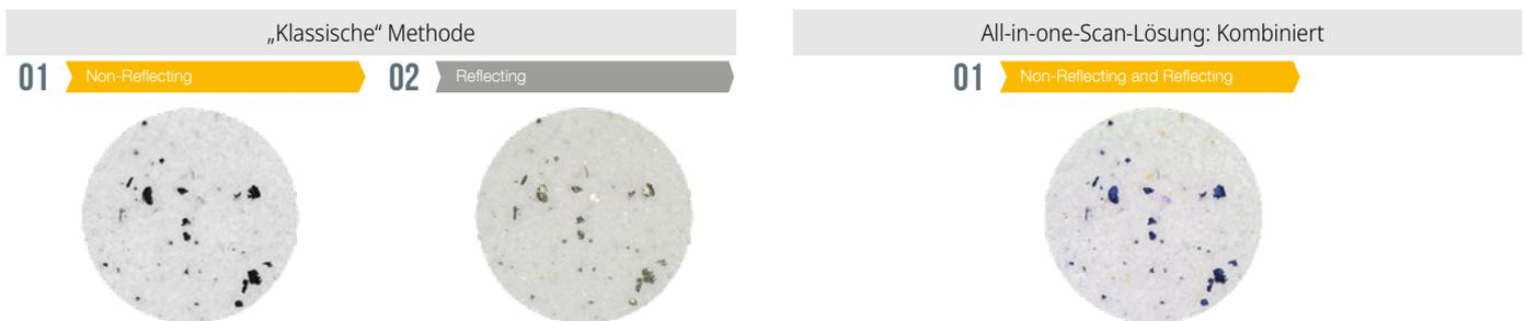
Das innovative Beleuchtungssystem trennt reflektierende (metallische) und nicht reflektierende (nichtmetallische) Partikel in einem einzigen Scan.
