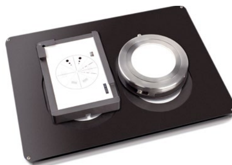
El estándar de calibración integrado permite desarrollar verificaciones regulares del sistema.
