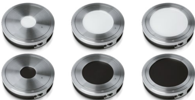
背景色が白と黒の直径25mm (左)、47mm (中)、55mm (右) のメンブレンフィルター用の円形サンプルホルダー
