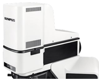
System oświetlenia i kamera zabezpieczone są osłoną chroniącą przed przypadkowymi przesunięciami.
