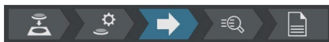
Duże przyciski wyświetlane podczas intuicyjnej procedury łatwo obsługuje się myszą lub na ekranie dotykowym. Etapy procedury od lewej do prawej: montowanie próbki, edycja ustawień, przeprowadzanie kontroli, przegląd wyników i tworzenie raportu.
