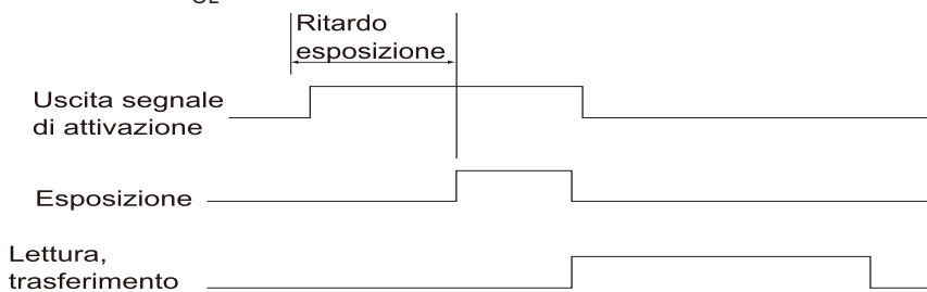
Diagramma della tempistica dell'acquisizione di un'immagine fissa (nel caso di impostazione di una logica positiva)
