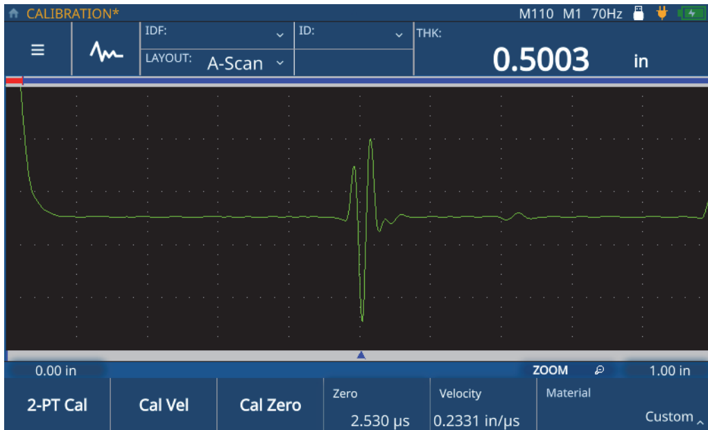
Figura 5-4 Completamento della taratura della velocità di propagazione dell'onda sonora
