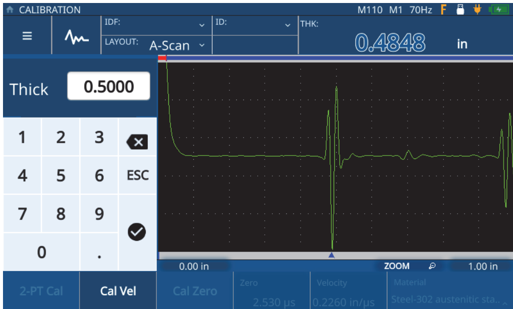
图 5-9 输入样件厚度
