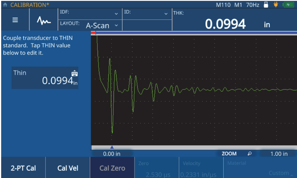
图 5-10 零位校准（2点校准）
