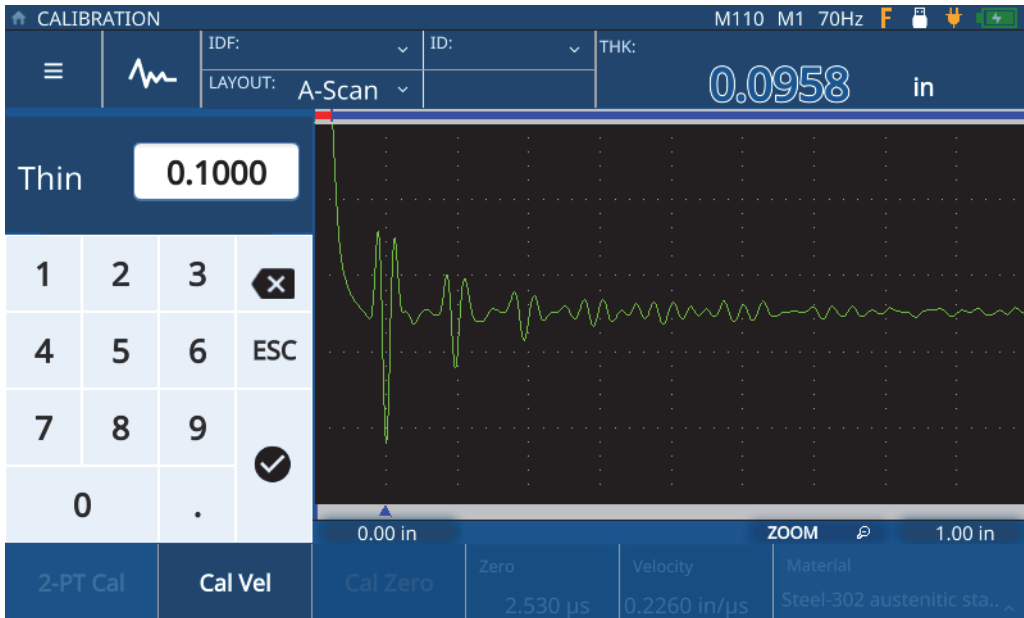
图 5-11 输入样件厚度
