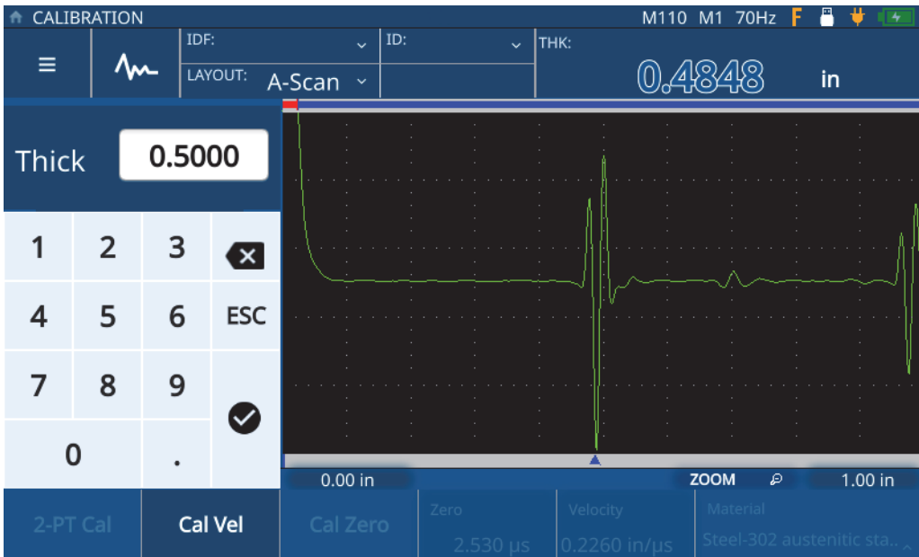
图 5-3 输入样件厚度
