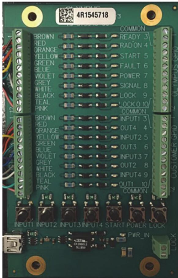
Abbildung 3-7 GPIO-Board
