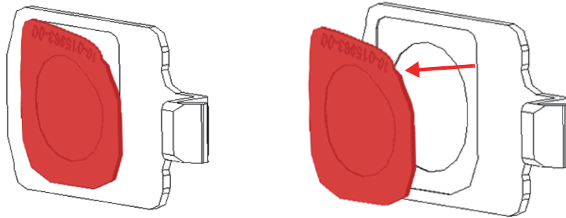
Figura 4-6 Desprendimiento de la ventana de medición (izquierda) y extracción (derecha)
