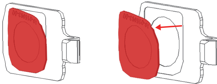
図 4-6 ウィンドウを剥がして (左) 取り外す (右)
