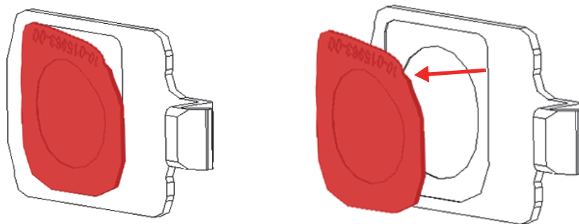
Rysunek 4-6 Odklejanie okienka (po lewej) i zdejmowanie go (po prawej)
