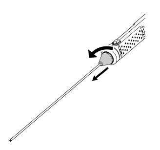
2. Conecte el alargador de empuñadura a la unidad de endoscopio rígida y fíjelo girándolo en el sentido de las agujas del reloj.
