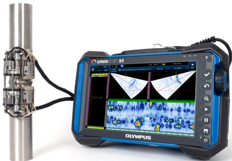
Der COBRA Scanner an einem 0,84 Zoll Rohr mit zwei A15 PA-Sensoren und einem OmniScan X3 Prüfgerät, das zwei PA-Gruppen mit Sektor-Scans und C-Bildern anzeigt.
