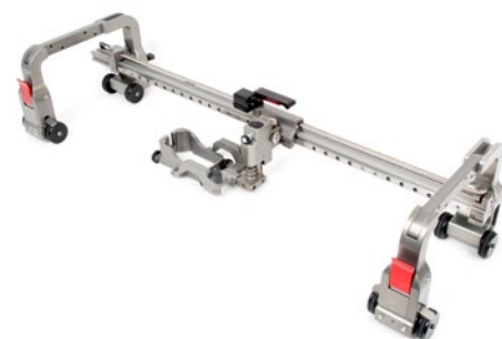
外径 4 インチ ~ 平面の強磁性面に使用可能な MapSCANNER ソリューションのバージョンがあります。
