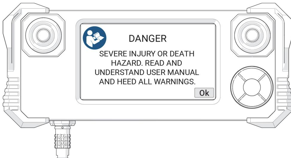
Figura 4- 3 Messaggio di avviso nel controller portatile
