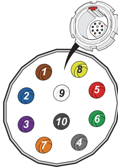
Figura 8-4 Configurazione della piedinatura
