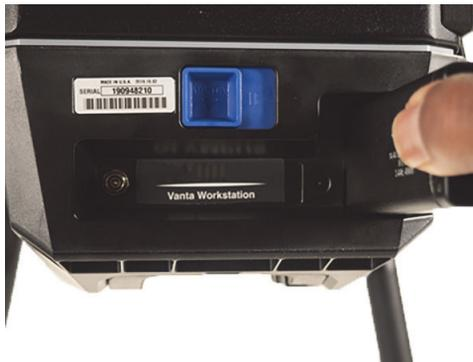
**Abbildung B-11 Einlegen des Akkus**
