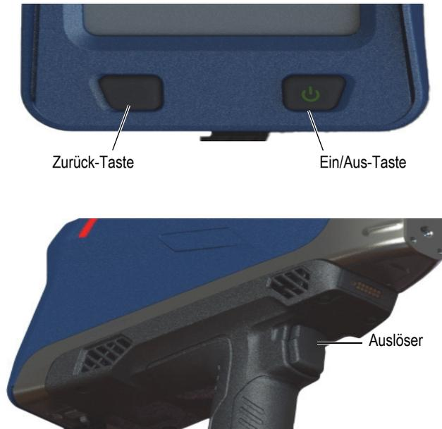
**Abbildung 3-8 Externe Bedienelemente des Vanta**
