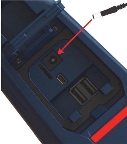
Abbildung 3-5 Anschluss des Gleichstromsteckers
