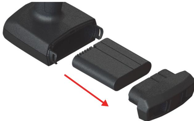
**Abbildung 3-10 Entfernen Sie den Akku**
