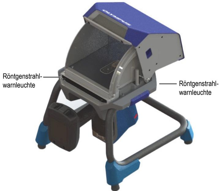
**Abbildung B-1 Röntgenstrahlwarnleuchte am Teststand**
