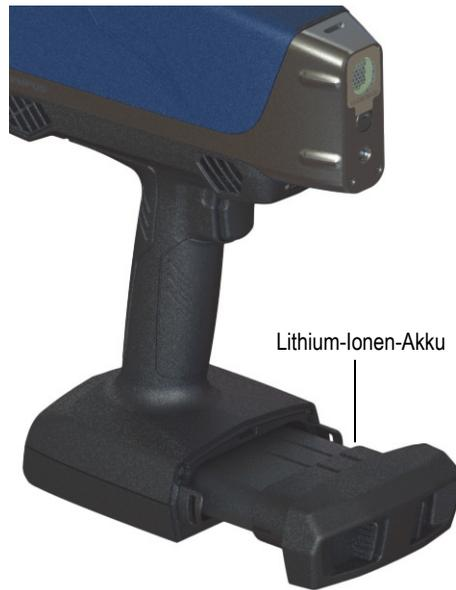
Abbildung 2-2 Vanta Lithium-Ionen-Akku
