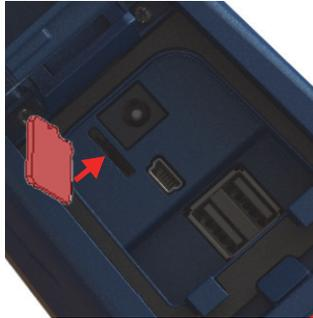
**Abbildung 3-6 Einsetzen der microSD-Karte**
