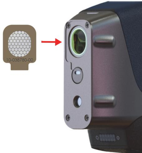
Abbildung 4-3 Neues Messfenster mit Messkopf ausgerichtet
