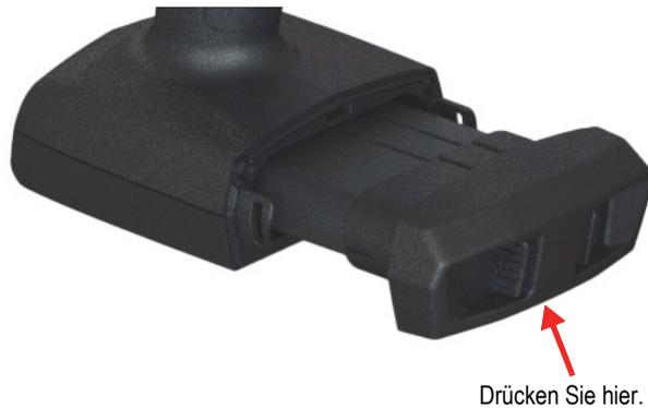
**Abbildung 3-9 Entriegelungstasten des Akkus**
