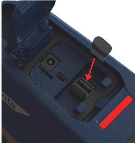
**Figura 3-7 Introducción del adaptador Wi-Fi®**
