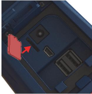
**Figura 3-6 Instalación de la tarjeta de memoria microSD**
