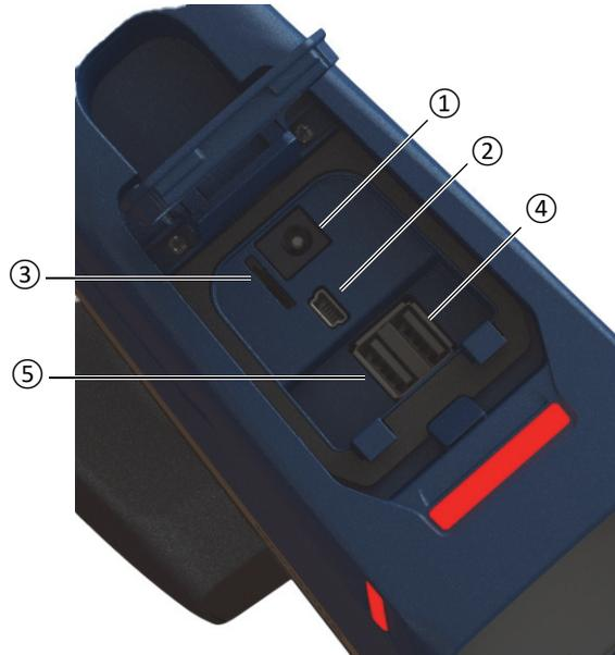
**Figura 3-3** Conectores de E/S del puerto de datos
