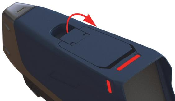
**Figura 3-1 Desbloqueo de la cubierta**
