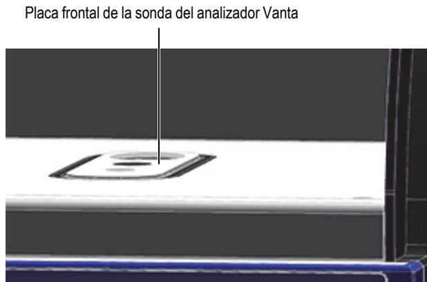
**Figura B-14 Nivel de la placa frontal de la sonda del analizador Vanta con el piso de la cámara de la estación de trabajo**
