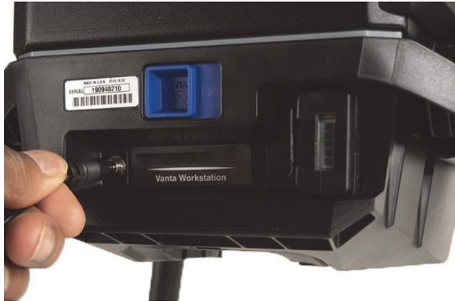
Figura B-12 Conectar la fuente de alimentación de CC
