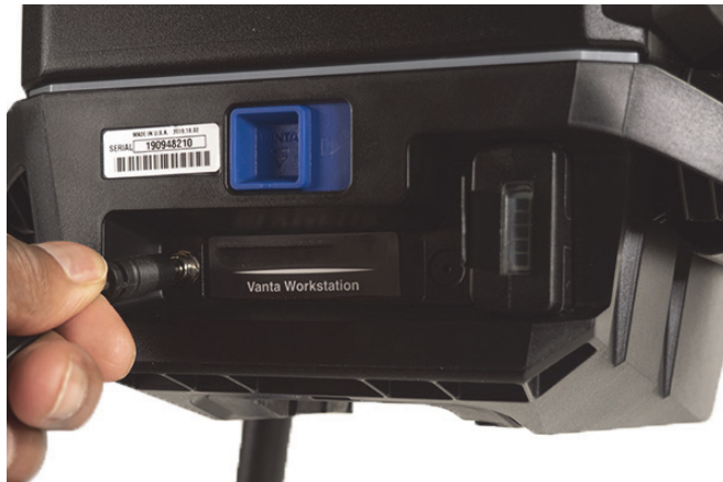
Figure B-12 Connexion de l'alimentation c.c.
