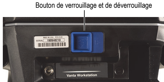
Figure B-15 Bouton de verrouillage et de déverrouillage
