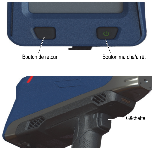
Figure 3-8 Commandes externes de l'analyseur
