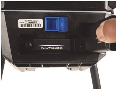
Figure B-11 Insertion de la batterie
