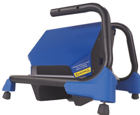
Figure B-17 Chambre d'analyse placée à l'intérieur du support
