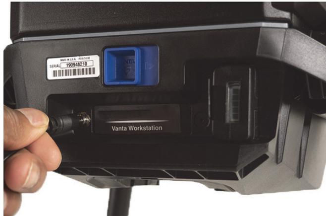
**Figura B-12 Collegamento dell'alimentazione da rete elettrica**
