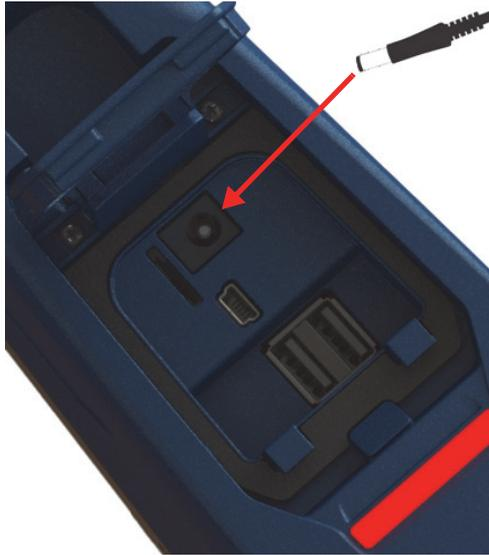
Figura 3-5 Collegamento della spina di alimentazione CC
