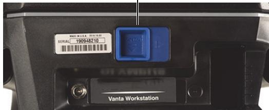
**Figura B-15** Dispositivo di bloccaggio e sbloccaggio del Vanta
