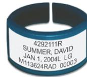
**Figura 1-5 Dosimetri — Vari modelli**
