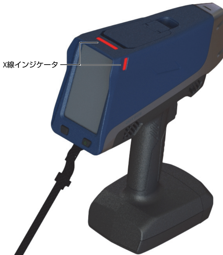
図 1-2 X線インジケータ（上部および側面）
