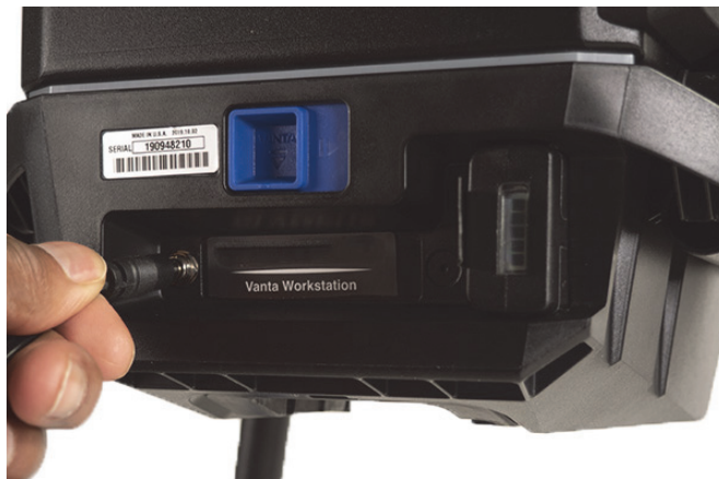
図 B-12 DC 電源を接続する
