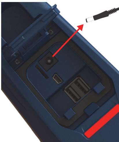
図 3-14 DC 電源プラグを抜く
