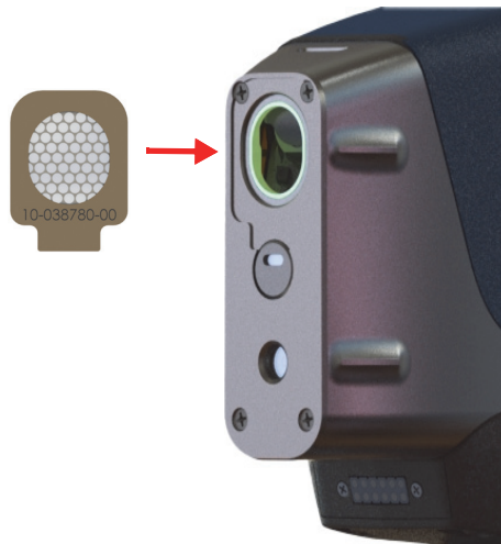
図 4-3 プロブと位置合わせされた新しいウィンドウ
