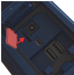
図 3-6 microSD カードの挿入
