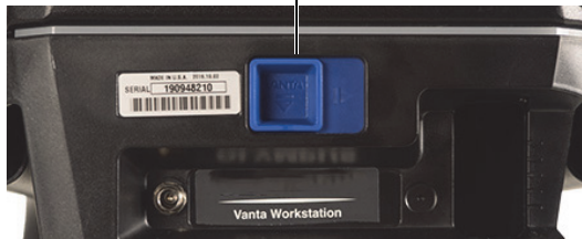
図 B-15 Vanta のロックおよびロック解除ラッチ
