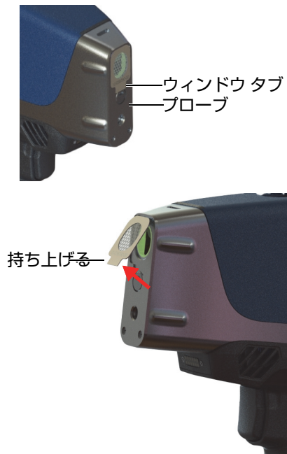
図 4-1 Vanta のウィンドウの取り外し
