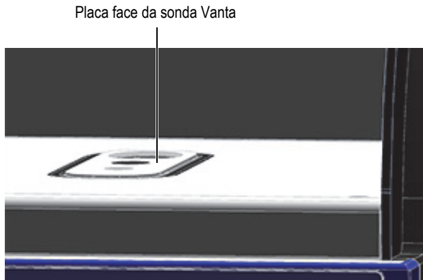
Figura B-14 Placa face da sonda Vanta nivelada com o chão da câmara da Estação de trabalho
