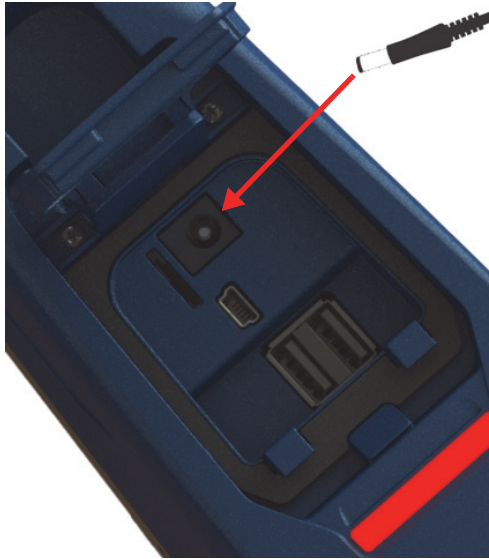
Figura 3-5 Conexão do plugue de energia CC
