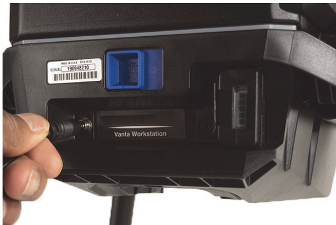
图 B-12 连接DC电源
