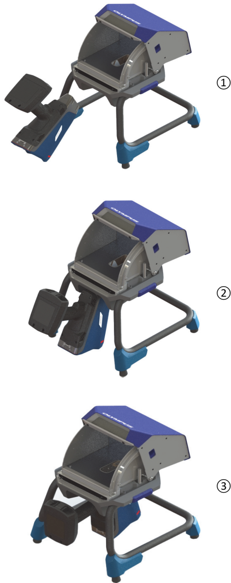
图 B-13 安装顺序：将Vanta分析仪插入到工作站
