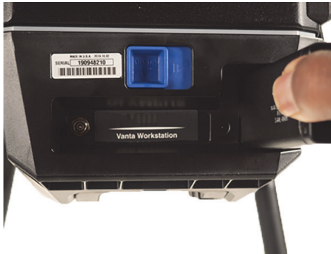
图 B-11 将电池插入到电池舱中
