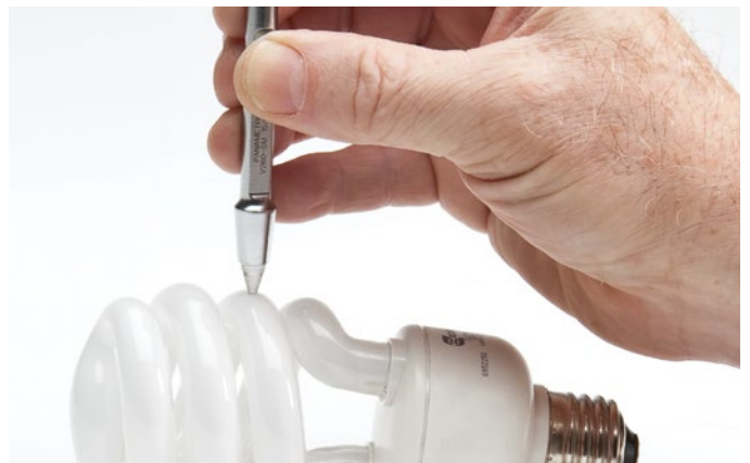
고해상도 소프트웨어 옵션을 사용하면 최대 0.001mm(0.0001인치) 해상도로 두께를 측정할 수 있습니다.
