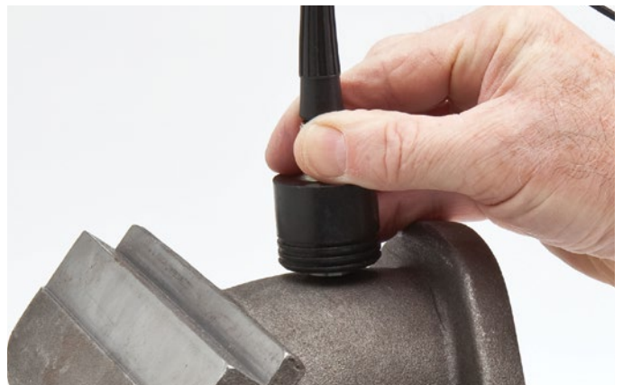
높은 침투성 소프트웨어 옵션으로는 여러 주조 금속 부품 또는 소리 감쇠 재료를 측정할 수 있습니다.
