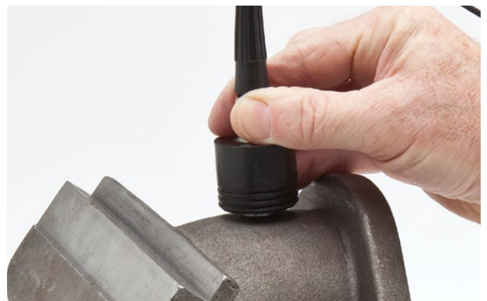
高穿透软件选项可以对许多铸造金属部件及声波衰减性较强的材料进行测量。
