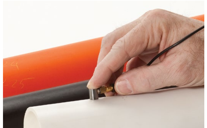
可测量包括塑料、金属、橡胶、玻璃、陶瓷及复合材料在内的很多材料的厚度。
