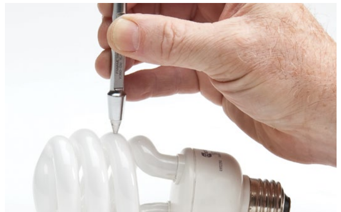
高分辨率软件选项可进行分辨率高达0.001毫米的厚度测量。
