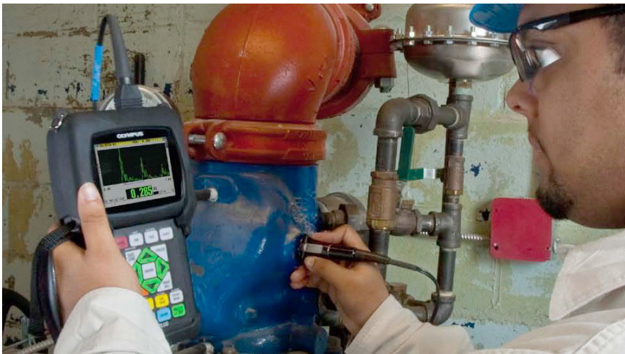
Abbildung 1-1 Messen der Dicke mit dem 39DL PLUS
