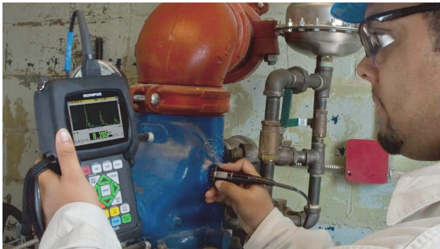
Abbildung 1-1 Messen der Dicke mit dem 39DL PLUS
