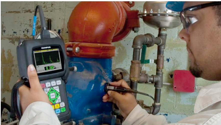
Figura 1-1 Medição de espessuras com o 39DL PLUS
