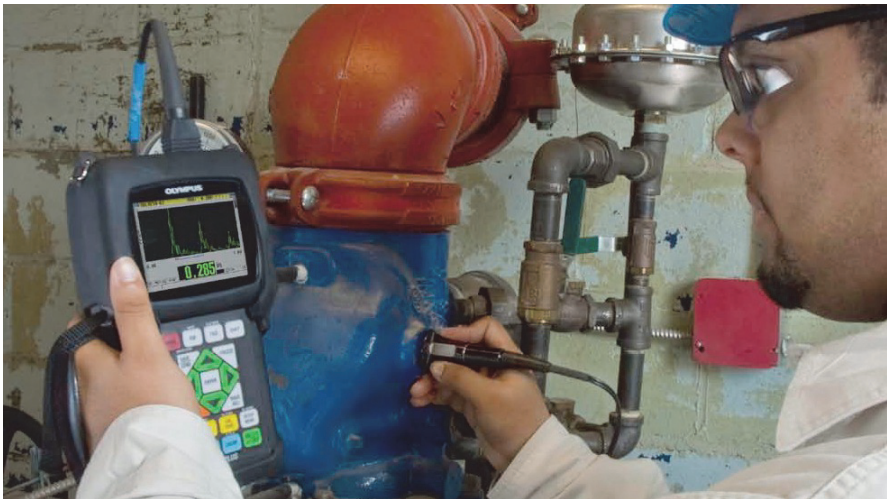
图 1-1 使用 39DL PLUS 仪器测量材料的厚度
