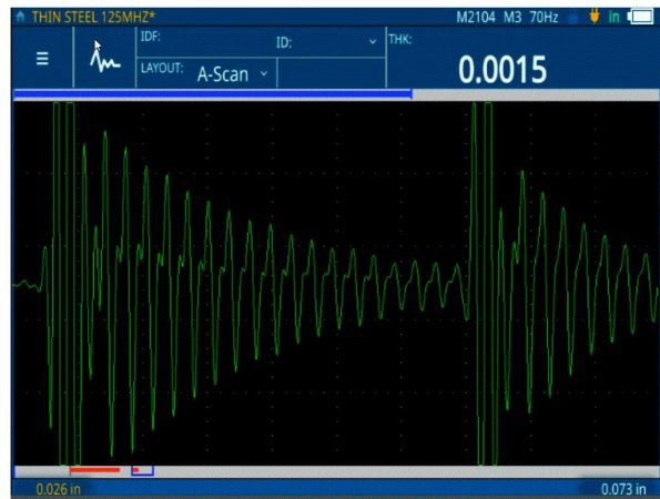
72DL PLUS超声波测厚仪使用M2104（125 MHz）探头测量薄钢板（0.0381 mm）
