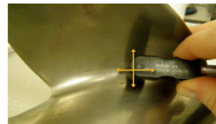
涡流检测扫描螺旋桨示例
