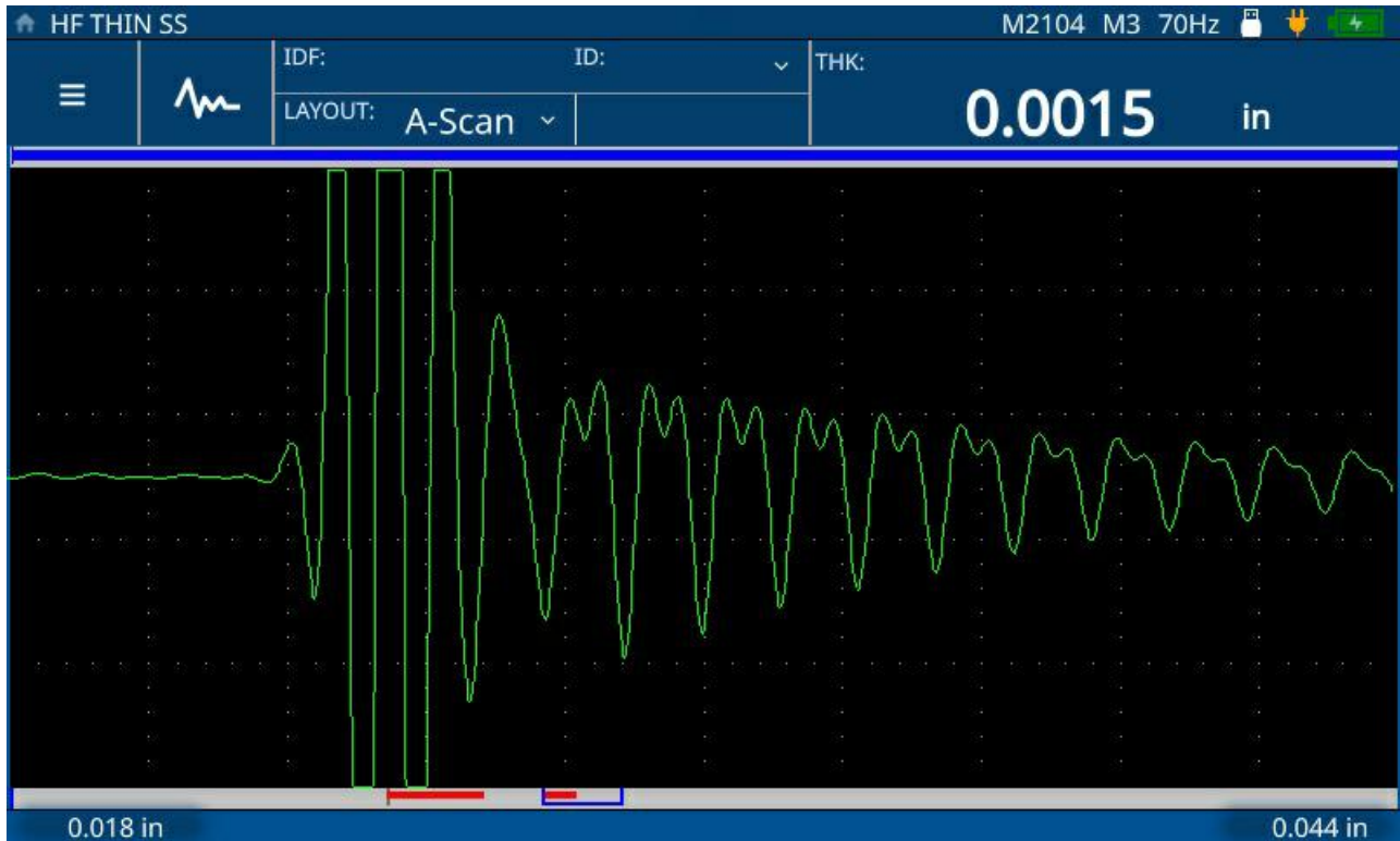
72DL PLUS超声波测厚仪使用M2104（125 MHz）探头测量薄钢板（0.0381 mm）
