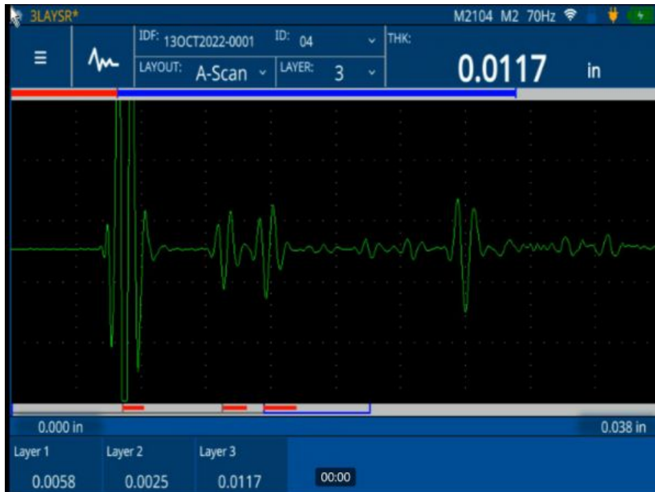
使用72DL PLUS超声测厚仪对三层塑料容器进行50 MHz测量
