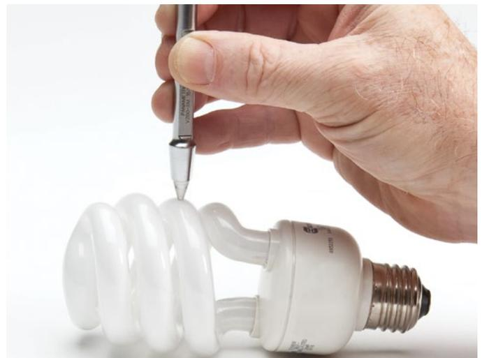
Die Softwareoption für hohe Auflösung ermöglicht Dickenmessungen mit einer Auflösung bis zu 0,001 mm.
