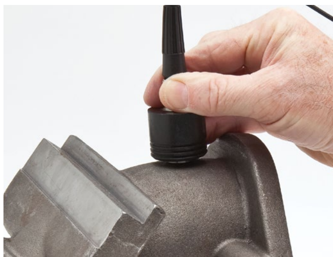
ハイペネトレーションソフトウェアオプションにより、鋳造部品などの超音波減衰材料の肉厚測定が可能
