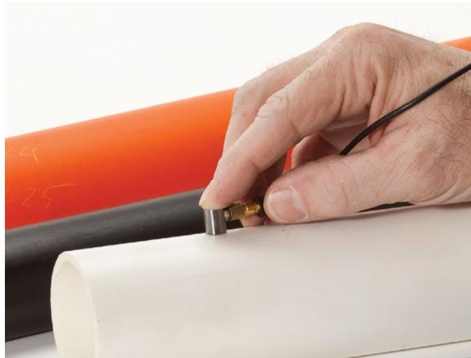
Mede a espessura de vários materiais como plástico, metal, borracha, vidro, cerâmica e compósitos.
