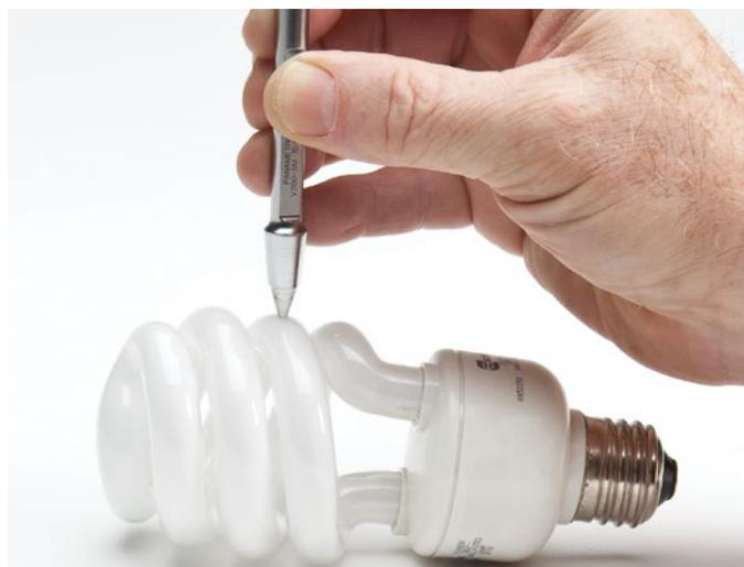
O software opcional High Resolution permite a medição de espessura de até 0,001 mm (0,0001 pol.) de resolução.
