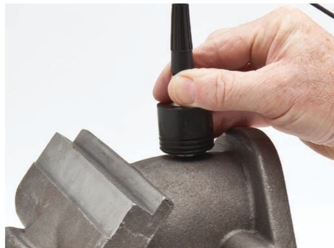
Опция «High Penetration» (повышенное проникновение) для измерения толщины массивных литых деталей или материалов с высоким затуханием ультразвука.
