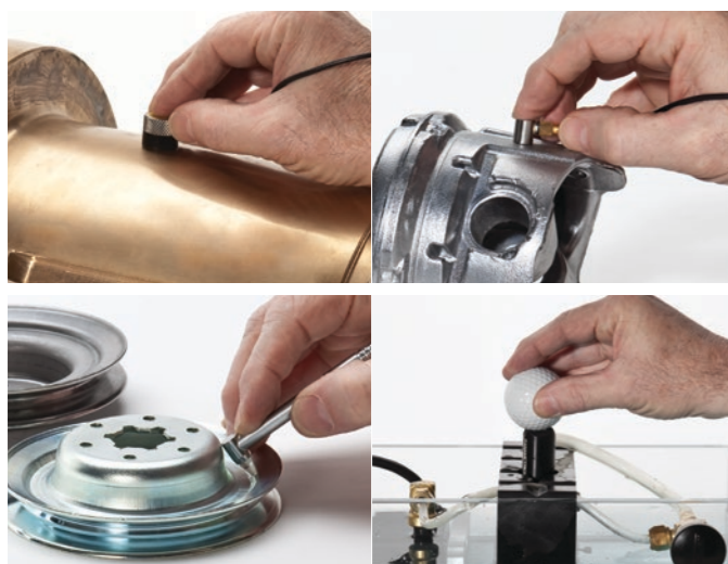
Ультразвуковой метод измерения толщины обеспечивает точные, надежные и воспроизводимые результаты. Контроль проводится при одностороннем доступе к изделию, без необходимости его демонтажа или разрушения.
