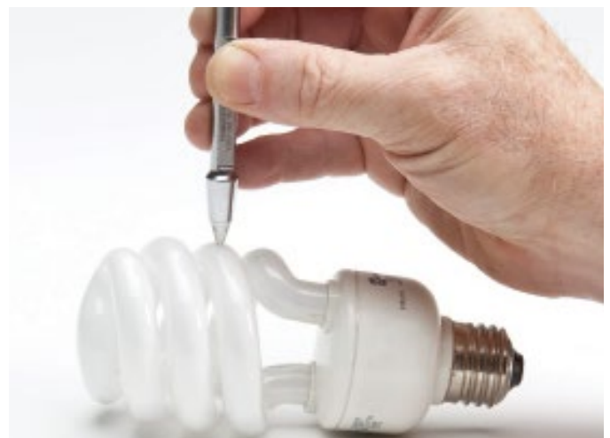
高分辨率软件选项可进行分辨率高达0.001毫米的厚度测量
