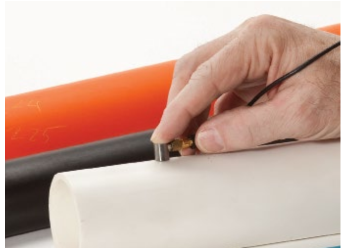
可测量包括塑料、金属、橡胶、玻璃、陶瓷及复合材料在内的很多材料的厚度
