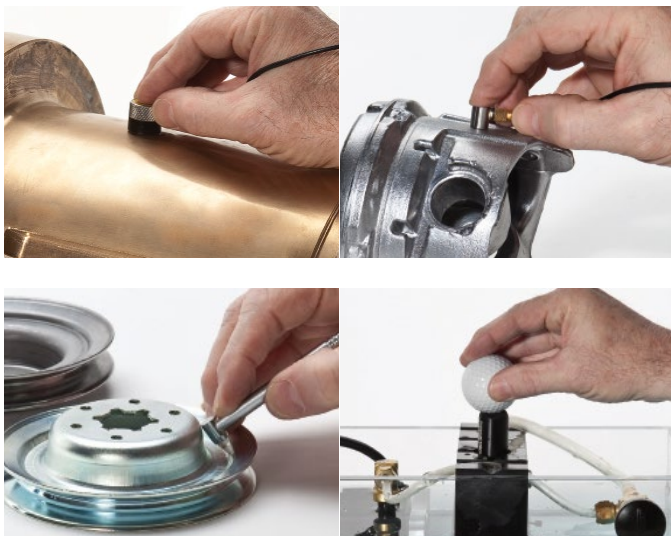
利用超声技术测得的厚度值准确、可靠，并具有可重复性。从材料一侧进行测量即可马上得到厚度读数，因此无需因切开工件而损坏工件。
