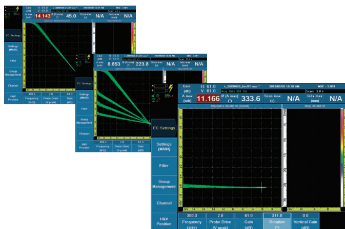
OmniScan のスクロールノブで、リアルタイムに位相角を調整可能。ゲイン、縦ゲイン、ヌル (バランス) ポイント (H/V) も同様に調整可能。
