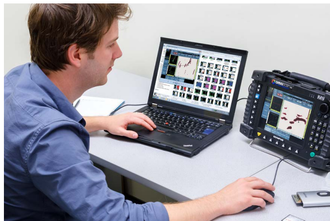
マウス入力によりデータ解析を短時間で効率的に行います。CompactFlash リーダーを使い PC にファイルを転送することができます。
