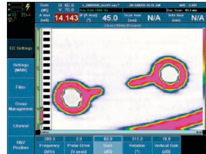
Ajuste do contraste com ganho na exibição completa de C-scan.
