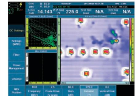
Revestimento de aeronave com indícios de corrosão. As cores indicam a profundidade dos defeitos.
