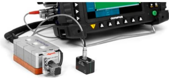
A conexão simultânea das sondas ECA e ECT fornecem a melhor ferramenta de trabalho sem a necessidade de reconfigurar o hardware.
