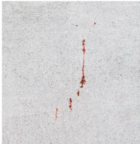
Peça inspecionada com a técnica de teste de penetração (corante vermelho visível)
