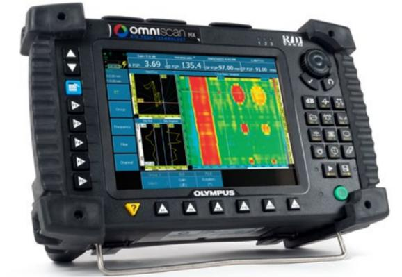
Detector de defeitos OmniScan MX1 com módulo de correntes parasitas multielementos
