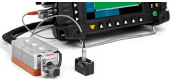
同时连接ECA and ECT探头是一种有效的工作方式，因为用户无需停下操作，重新配置硬件设置。
