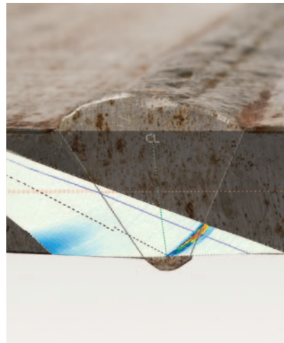
OmniScan扇形扫描，带有显示裂缝指示的焊缝覆盖。
