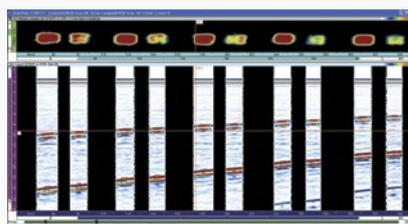
Таким образом, А-сканы располагаются только в местах наибольшей значимости, позволяя максимально расширить площадь исследования за один подход.
