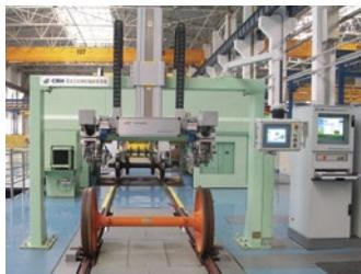
TomoView, в сочетании с библиотеками доступа к данным, представляют идеальный инструментарий для создания гибкой системы контроля железнодорожных колес и осей.
