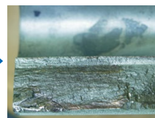
Osvětlení horní části povrchového lomu (kov)
