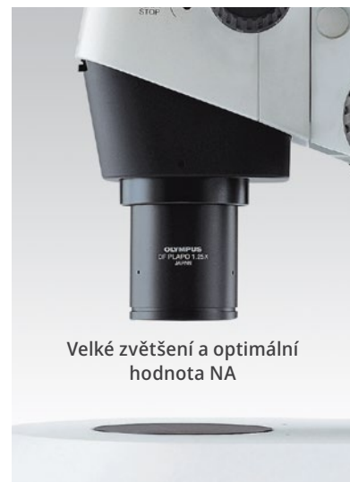
1,25x pro velké zvětšení a optimální hodnotu NA
