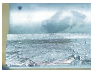
Vierteilige Ausleuchtung eines Oberflächenbruchs (Metall)
