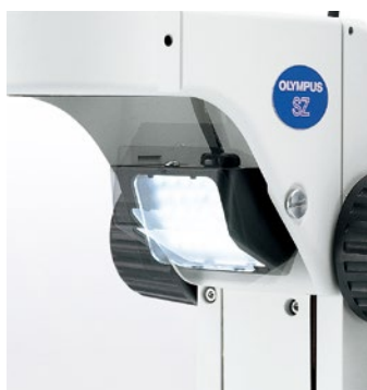
Flexibler Winkel der LED-Lichtquelle
