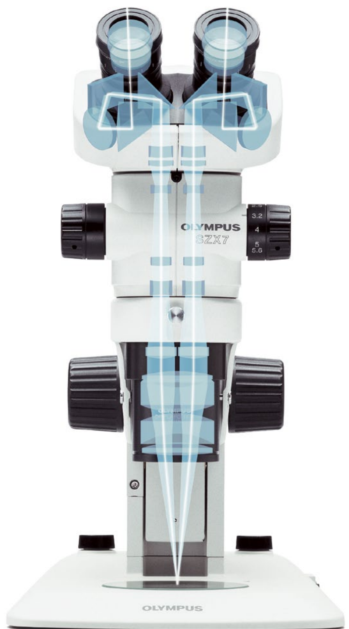
Le ottiche galileiane integrano due (destra/sinistra) percorsi ottici zoom indipendenti e paralleli per generare il punto focale con un obiettivo. Il sistema permette delle elevate prestazioni ottiche e una modularità funzionale.
