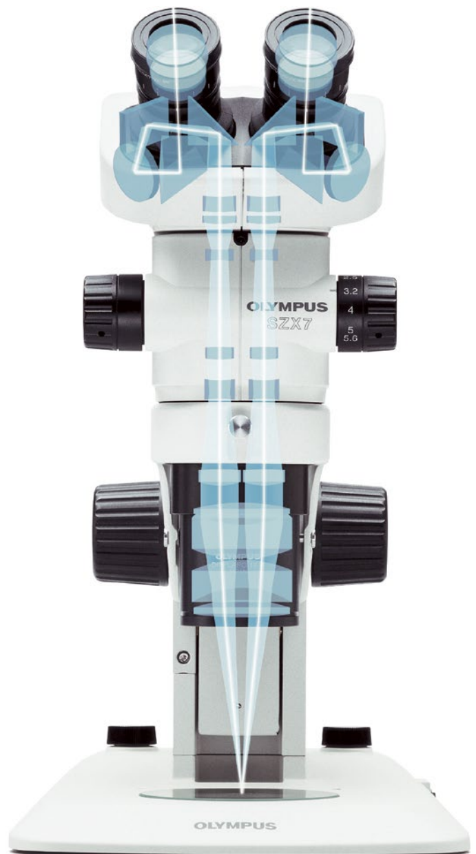
伽利略光学系统具有两个（左 / 右）独立且平行的变倍光路，可通过一个物镜产生焦点。该系统能够实现高光学性能以及功能模块化。
