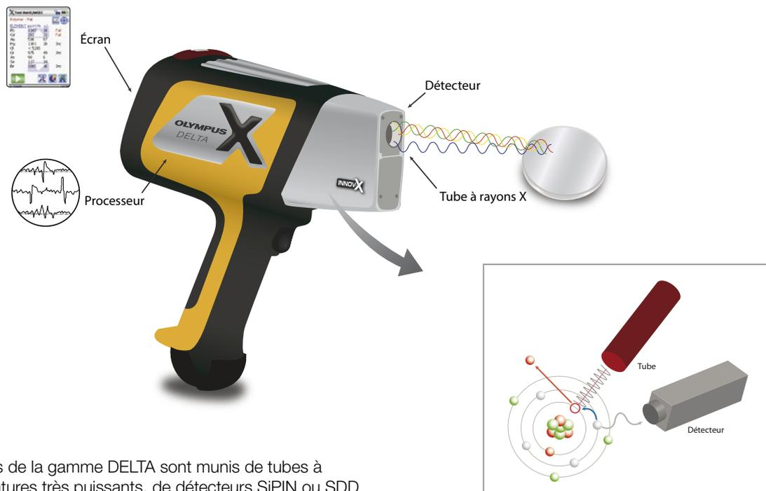
Les analyseurs de la gamme DELTA sont munis de tubes à rayons X miniatures très puissants, de détecteurs SiPIN ou SDD hautement avancés, de filtres spéciaux et d'une option d'optimisation multifaisceau qui en font les appareils par excellence pour l'analyse XRF.
