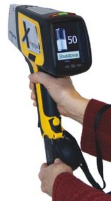
De conception unique, la station d'accueil DELTA permet de n'avoir jamais à éteindre l'analyseur. La station charge la batterie de l'analyseur et la batterie de rechange, en plus d'effectuer périodiquement une vérification de l'étalonnage. Les appareils DELTA peuvent fonctionner sans interruption grâce à la batterie remplaçable à chaud.
